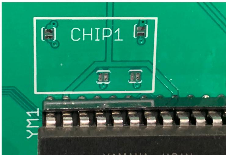
En suivant les instructions imprimées sous le circuit imprimé, vous devez simplement ajouter un petit peu de soudure à travers les 4 tampons sautant pour activer la YM2612 et retirer la soudure pour réactiver la YM3438 par défaut.
