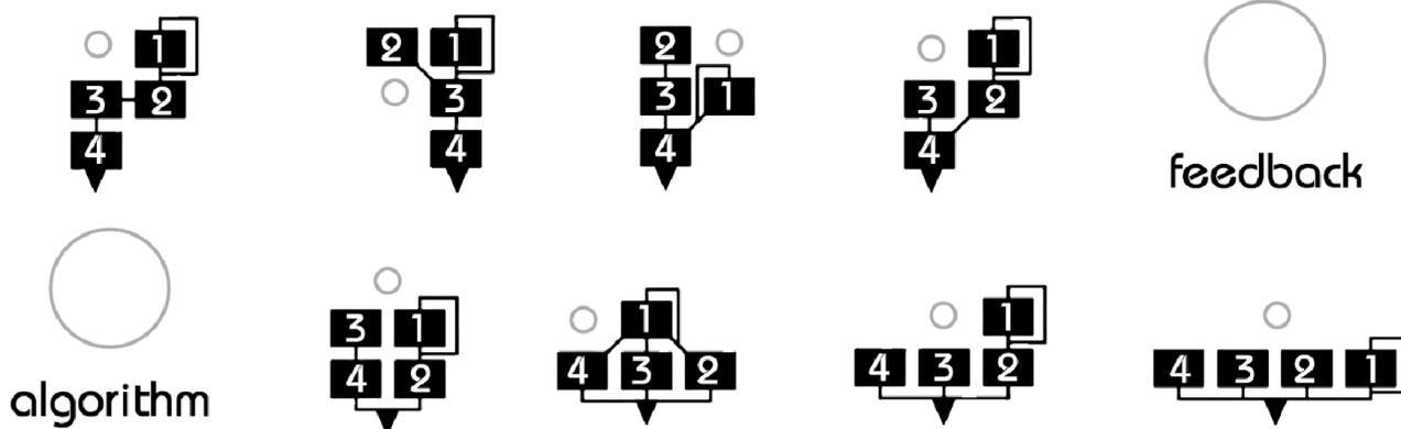
Utilisez le bouton « algorithm » pour sélectionner un des 8 algorithmes et le bouton « feedback » pour définir la quantité de retour « feedback » de l'opérateur 1.
